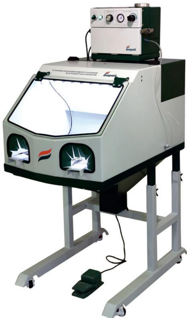
1 Установка микроабразивного удаления влагозащитных покрытий «Борей»
