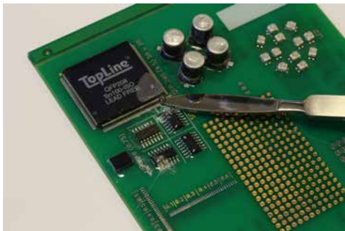
1 Снятие влагозащитного покрытия с помощью скальпеля
