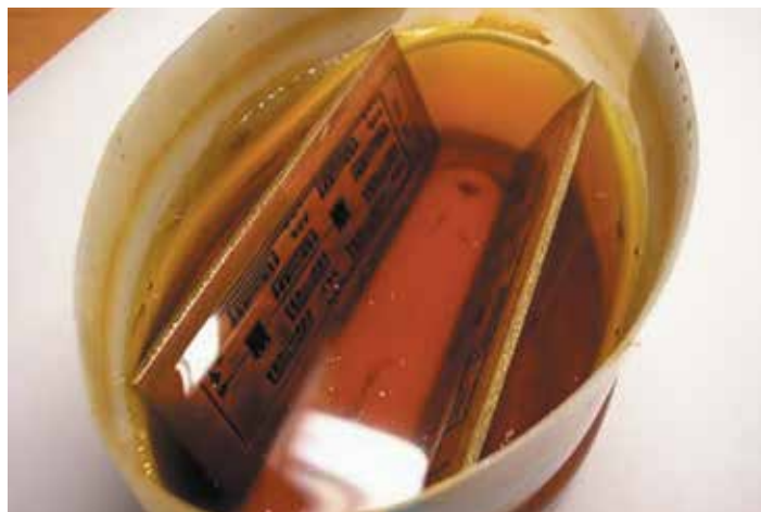
2 Вымачивание печатного узла в растворителе для снятия УР-231
